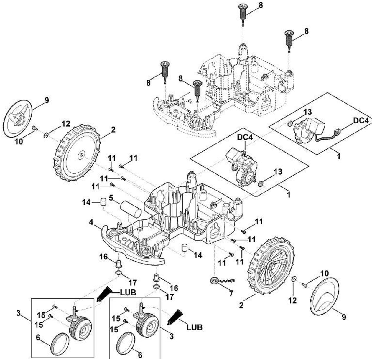
DC4 Avant de brancher le câble, remplir la broche femelle de graisse spéciale (DC4).
