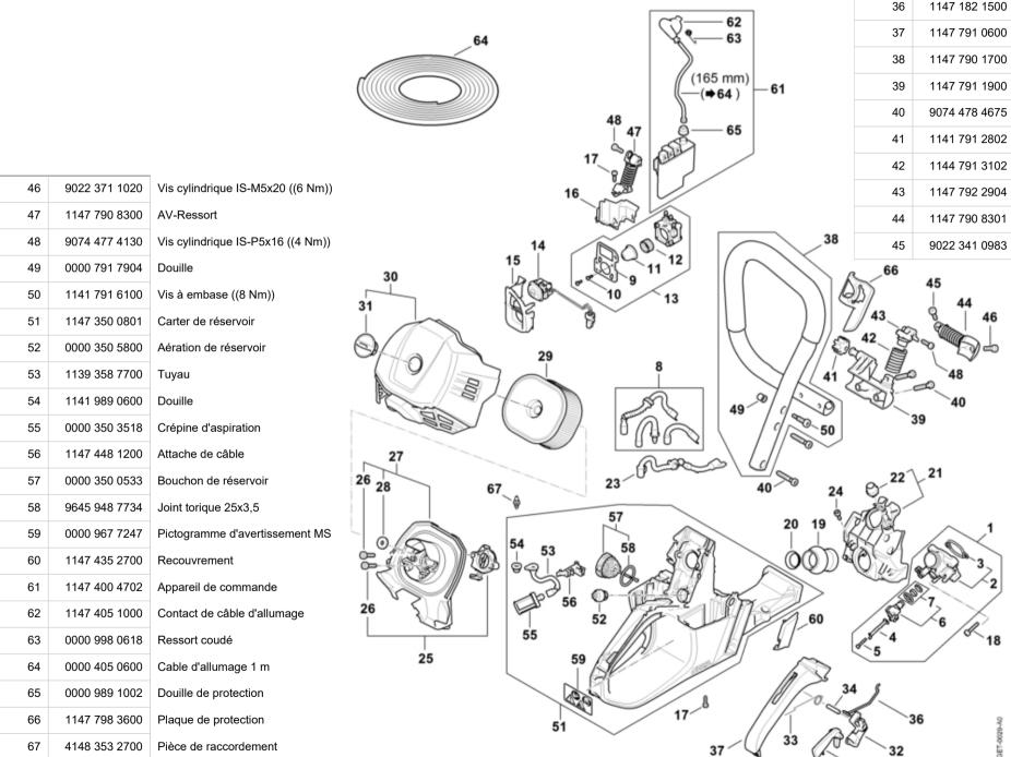
1138 182 4500 33 Ressort coudé 34 9371 470 2630 Goupille cylindrique 5m6x22 35 1141 182 0800 Levier d'arrêt 36 1147 182 1500 Tringlerie des gaz Monture de poignée Poignée tubulaire Crampon de tube de poignée Vis cylindrique IS-P6x32,5 ((6 Nm)) Butoir d'arrêt Ressort Bouchon de palier AV **AV-Ressort** Vis cylindrique IS-M5x16 ((10 Nm))
