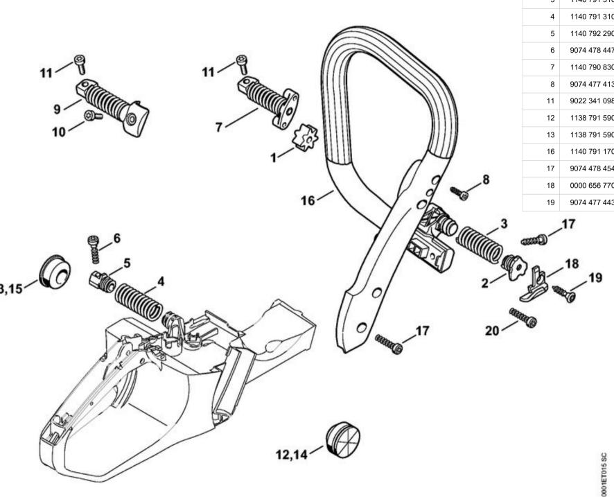
1140 791 2800 Butoir d'arrêt 1140 792 2900 Bouchon de palier AV 1140 791 3100 Ressort 1140 791 3102 Ressort 1140 792 2903 Bouchon de palier AV 9074 478 4475 Vis cylindrique IS-P6x21,5 1140 790 8300 AV-Ressort Vis cylindrique IS-P5x16 9074 477 4130 9022 341 0983 Vis cylindrique IS-M5x16 1138 791 5903 Butoir d'arrêt 1138 791 5902 Butoir d'arrêt Poignée tubulaire 1140 791 1703 Vis cylindrique IS-P6x26,5 9074 478 4545 0000 656 7700 Arrêt de chaîne 9074 477 4438 Vis cylindrique IS-P6x30
